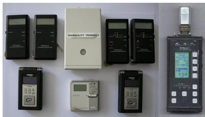
Photo 27 : Détecteurs-amplificateurs d'ultrasons et enregistreurs numériques utilisés lors de l'étude
