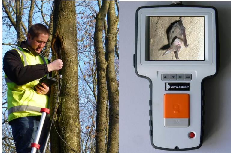
Photo 26 : Visite d'une cavité et endoscope V-SCOPE utilisé par IEA
