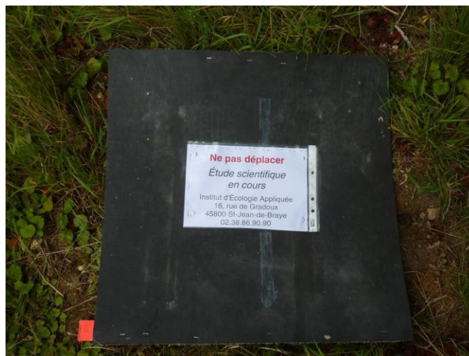
Photo 25 : Plaque de caoutchouc de 60 x 60 cm utilisée par IEA
